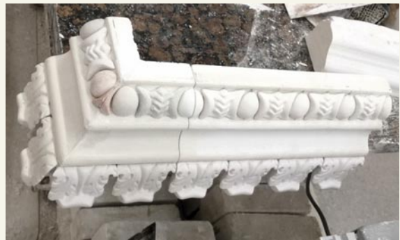
Eine neue Krone nach originaler historischer Vorlage wird von dem Modelleur Veiko Minge gefertigt. Viel präziser als das Original und schärfer im Relief. Jede Form für Reimann's KRONA entsteht als komplette Neufertigung und nicht als einfacher Abdruck einer alten Form
