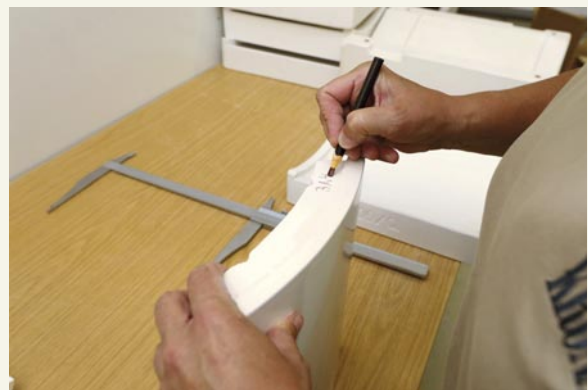
Jede Kachel wird mit dem Messschieber vermessen, Toleranz 1 mm. Das Maß wird auf dem Rumpf für den Ofenbauer notiert
