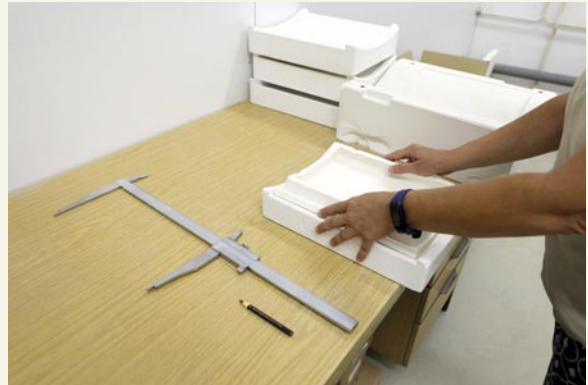
Die Kacheln werden auf Flügeligkeit geprüft, bis zu 1 mm sind erlaubt
