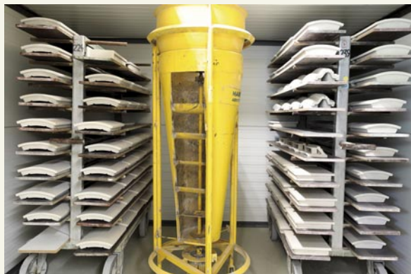
In der Trockenkammer wird der bereits vorgetrockneten Rohware die letzte Feuchtigkeit entzogen
