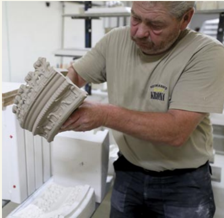
Eine Krone wird aus der Gießform entnommen
